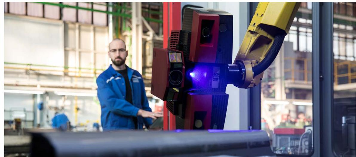
Quantensprung in der Qualitätskontrolle: durch optisches Messen fünfmal schneller als mit taktilen Verfahren.
